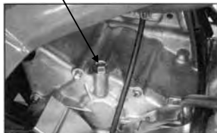
齒輪油注入孔螺栓
