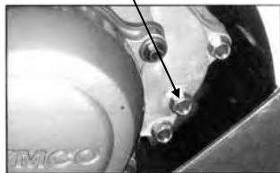
齒輪油注入孔螺栓
