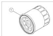
機油濾清器 鎖緊扭力值機油濾清器：17.5N.m
