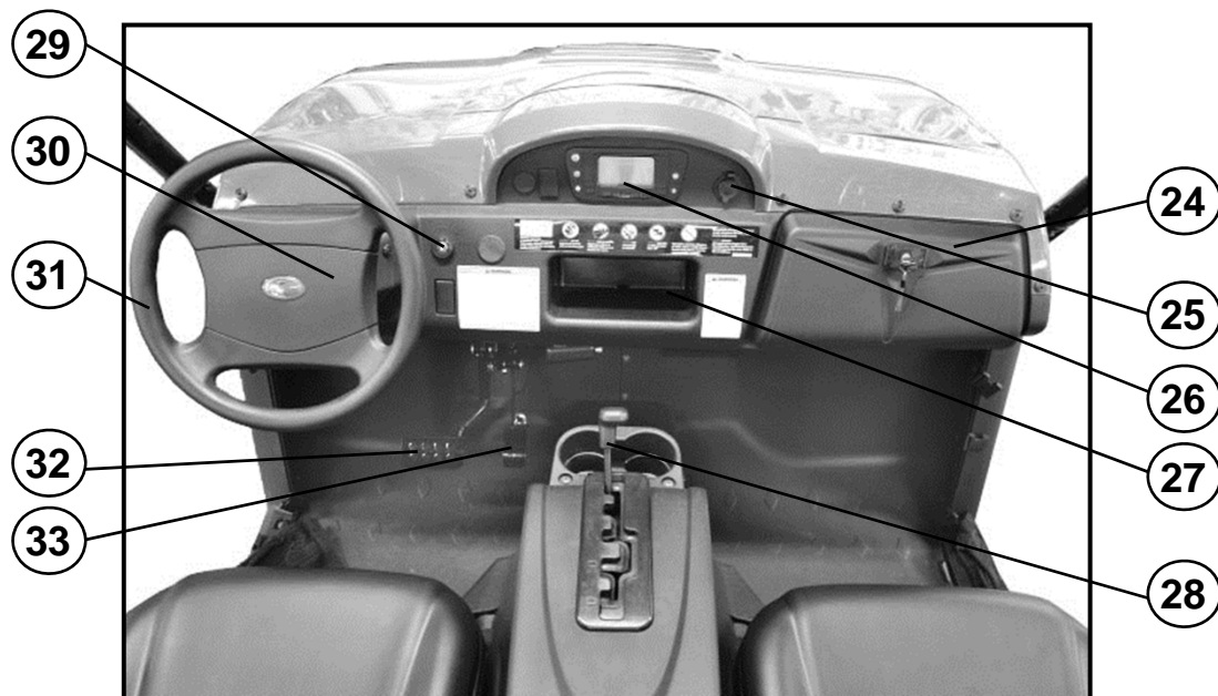
24.右置物箱 25. 輔助電源接頭 26.儀表板 27.中央置物箱 28.檔位選擇 29.點火開關30.喇叭 31.方向盤 32.煞車踏板33.油門踏板
