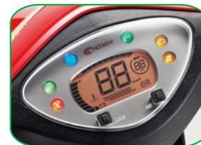
獨家DIS可行駛里程顯示，依據行駛速度、耗電量及目前電池電量，隨時更新可行駛的里程數，騎乘更安心。
