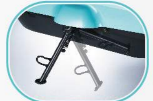
側支架斷電系統
